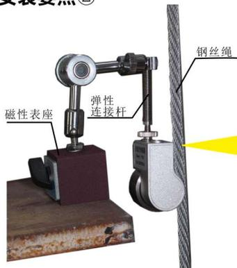
通过调整磁力表座的安装，使测速轮与钢丝绳平行；弹性连接杆也要与钢丝绳平行。测速轮具有磁吸力，应紧贴被测钢丝绳，尽量远离其它钢丝绳及导磁体。
