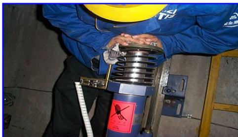
测试方法：作用力在顶端，垂直下压缓冲器
