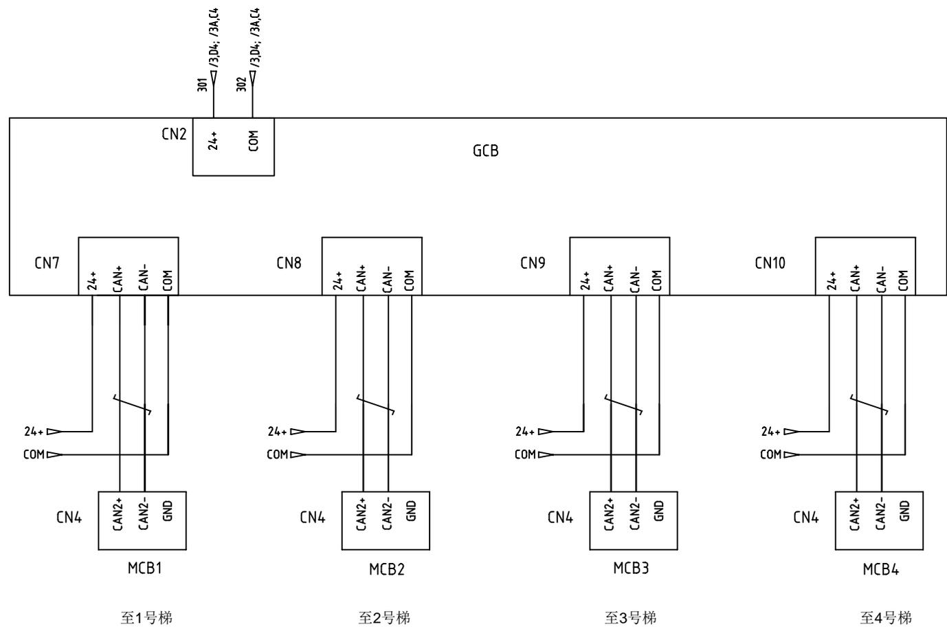
注：电缆连接线使用两两双绞屏蔽线。
